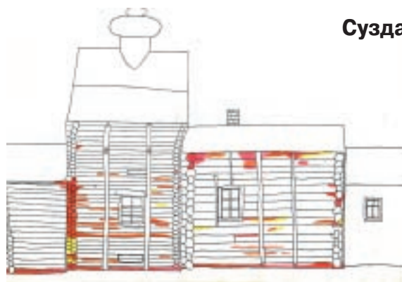
Рисунок церкви в селе Ковда с отмеченными местами прогнилости
